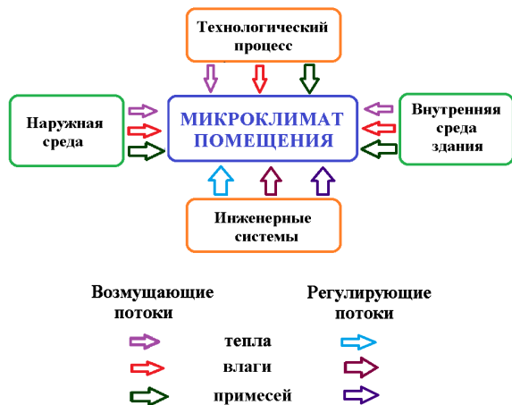
Рисунок 1 – Структурная схема формирования микроклимата
